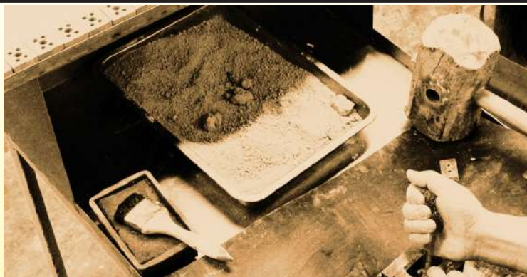
Клеммные колодки из фарфора, сделанные вручную путем прессования молотком: заполнение влажным гранулятом вручную (частная коллекция). Сушка электротехнического фарфора после прессования (частная коллекция).
