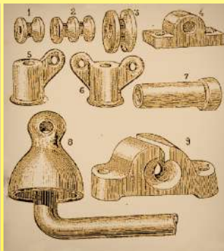
1885 год. Фарфоровые электроизоляторы (La physique moderne: l'électricité dans la maison, E. Hôpitalier)
